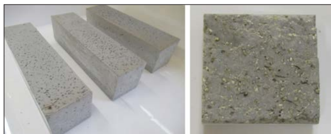
14. ábra: A zeolit felhasználásával készült keverék próbatestei
