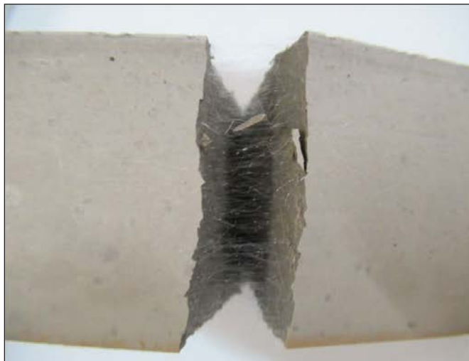
10. ábra: A PP szálakkal készített alapkeverék
