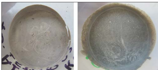
9. ábra: Az alapkeverék PP szálak nélkül (balra) és szálakkal (jobbra)
