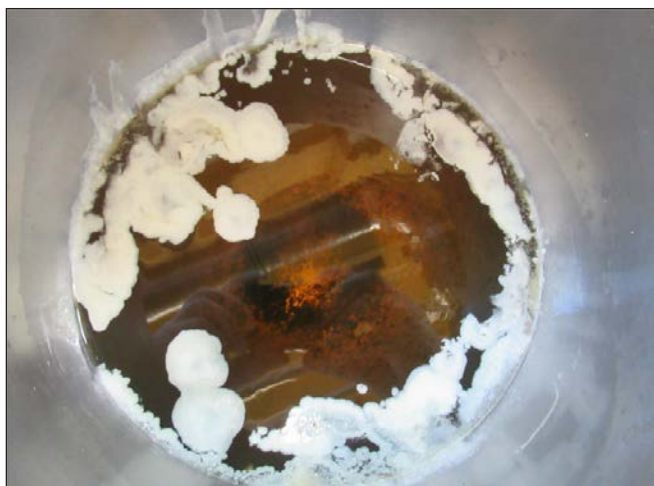
5. ábra: A Sika Control 60 tartalmú alkáli aktivátor sűrítmény
