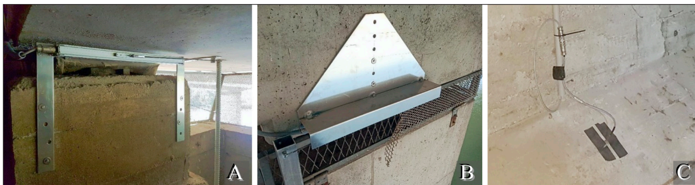
3. ábra: Hosszirányú elmozdulás mérése a 13 támasznál (A), a 15 támasznál (B) és hőmérsékletmérő a 14 támasznál (C)
