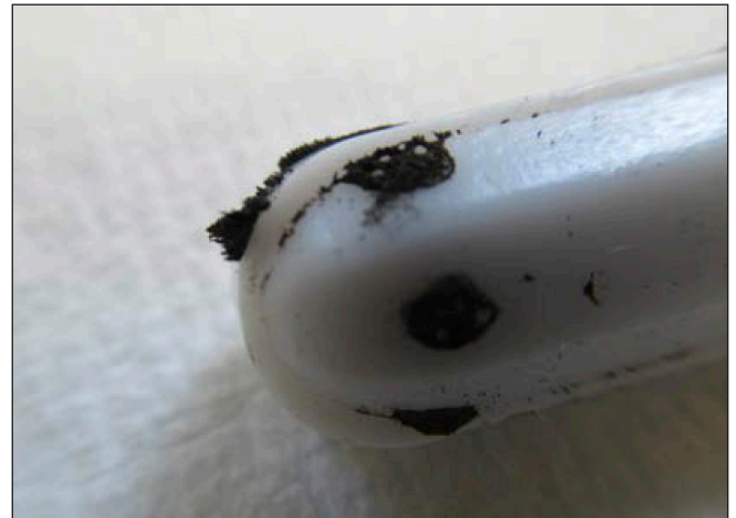
6. ábra: A mágneses keverőbotra tapadt vaspor
