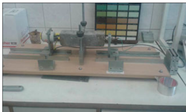
13. ábra: 70x70x250 mm-es próbatesszt önrengésszámának mérése. ÉMI
