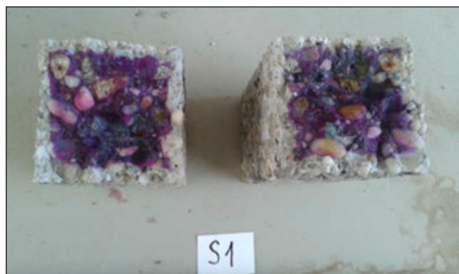
12. ábra: Az F&T beton fenolftaleines vizsgálata
