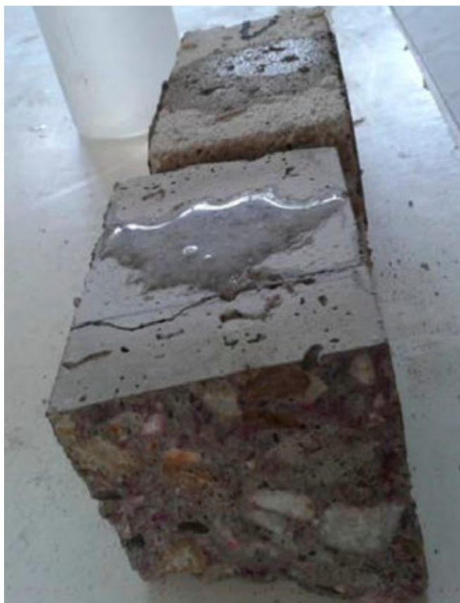
14. ábra: Vízben (elől) és ecetsavban (hátsul) tárolt beton próbatest nedvesedése
