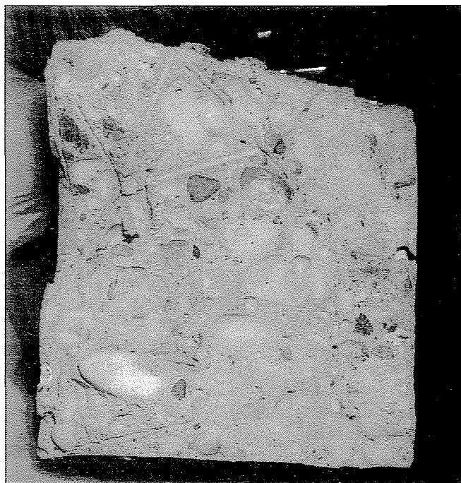
21 ábra: Makroszállal erősített beton felülete a törés után (400°C-os hőterhelés)
